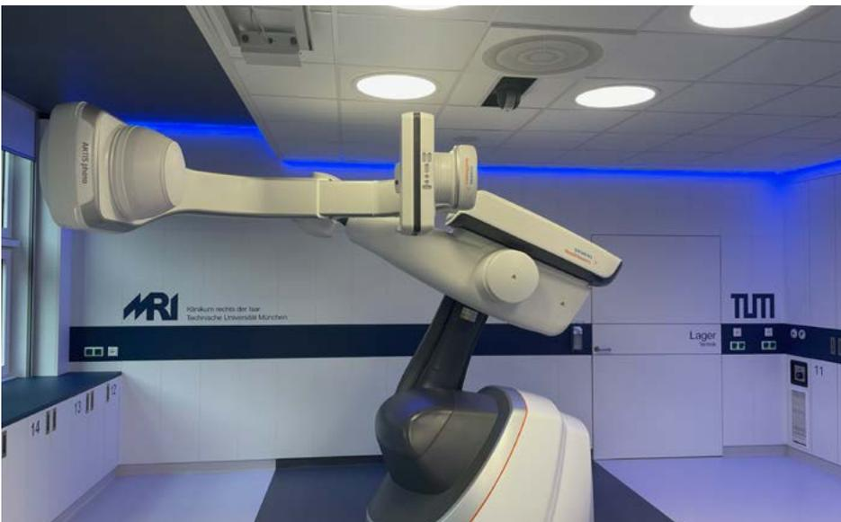
Abbildung 5: Robotertechnologie-basierendes Multiachsen-Angiografiesystem: unbegrenzte Flexibilität der Bewegungsgrade.
