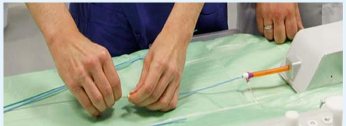
Abbildung 6 a und b: Angiografie-Simulator – mit der Hand ausgeführte analoge Bewegungen von Draht und Katheter werden im digital simulierten Patienten umgesetzt.
