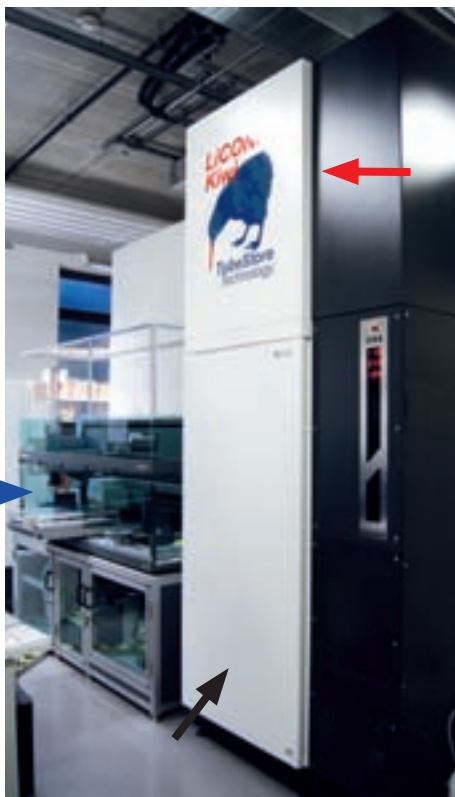
Abbildung 3: Temperatur-kontrolliertes automatisiertes (roboter-gesteuertes) Kryolager für die Lagerung flüssiger Biomaterialien mit angebundener Pipetierstraße (blauer Pfeil). Innerhalb der hermetisch abgeschlossenen, konstant auf -80 °C gehaltenen Gefriereinheit (schwarzer Pfeil) befindet sich bei diesem Modell ein Arbeitsbereich (roter Pfeil), in dem Temperaturen von zirka -20 bis -50 °C herrschen.
