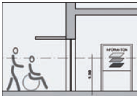
Orientierung im Gebäude durch Informationstafeln und ein weiterführendes Leitsystem.
