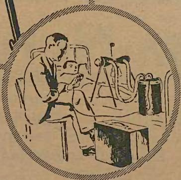
Wegen seines das Leitungsnetz nur gering belastenden Stromverbrauchs kann der „Metalix“-Apparat an jede Lichtsteckdose angeschlossen werden. Die Bedienung beschränkt sich auf wenige Handgriffe. Innerhalb kurzer Zeit läßt sich mit dem Apparat selbst am Bett des Patienten oder an einer Unfallstelle eine Röntgenaufnahme von großem diagnostischem Wert oder eine Durchleuchtung zur sicheren Beurteilung des vorliegenden Krankheitsfalles vornehmen.
